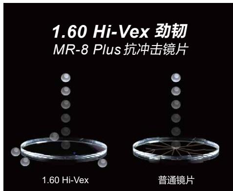
这次检测在美国佛罗里达的COLTS实验室完成，通过检测数个不同的镜片样品从高速冲击的落球实验结果中显示：镜片未发生断裂、镜片内表面未出现脱落甚至被穿透，经过测试项目的重重考验，该实验室得出结论：康耐特 1.60 Hi-Vex MR-8 Plus 镜片完全达到了ANSI Z87.1-2015高抗冲击的要求，镜片通过测试。
